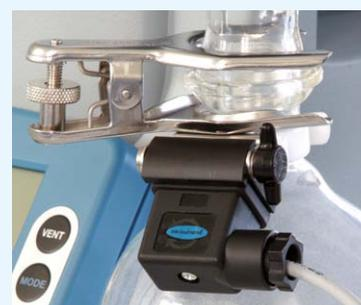
Apto para todos los condensadores de emisiones VACUUBRAND y trampas de entrada con conexión de vidrio esmerilado
