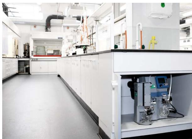
Instalación de la línea de vacío para el laboratorio en una universidad, equipado con condensador Peltronic®, sin conexión de agua de refrigeración en el interior del armario.
