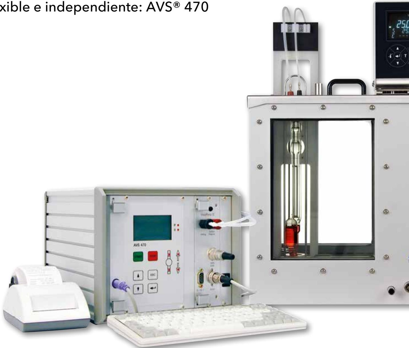
No se necesita una PC: mediciones de "succión" y "presión" con solo un instrumento
