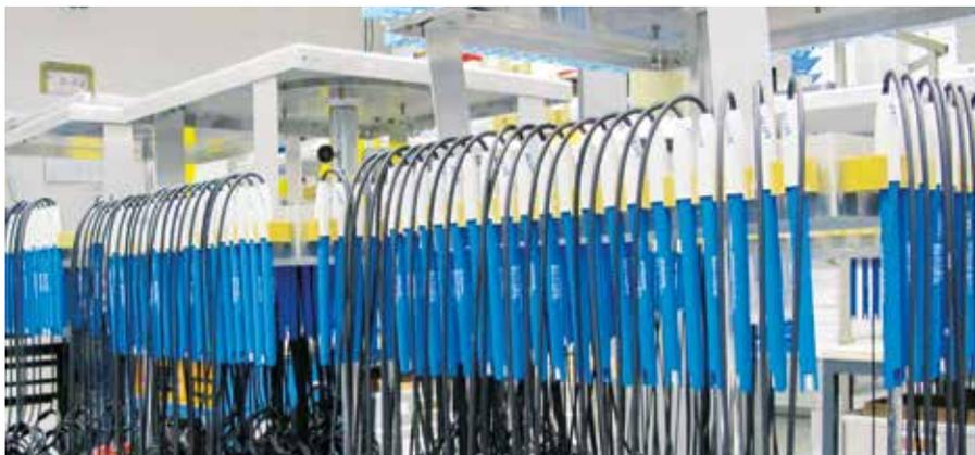
Revisiones de control de calidad exhaustivas son un elemento esencial desde el inicio hasta el fin de la producción. Se verifican el punto cero y el tiempo de respuesta de cada electrodo, como se muestra aquí con un lote de electrodos de laboratorio BlueLine.
