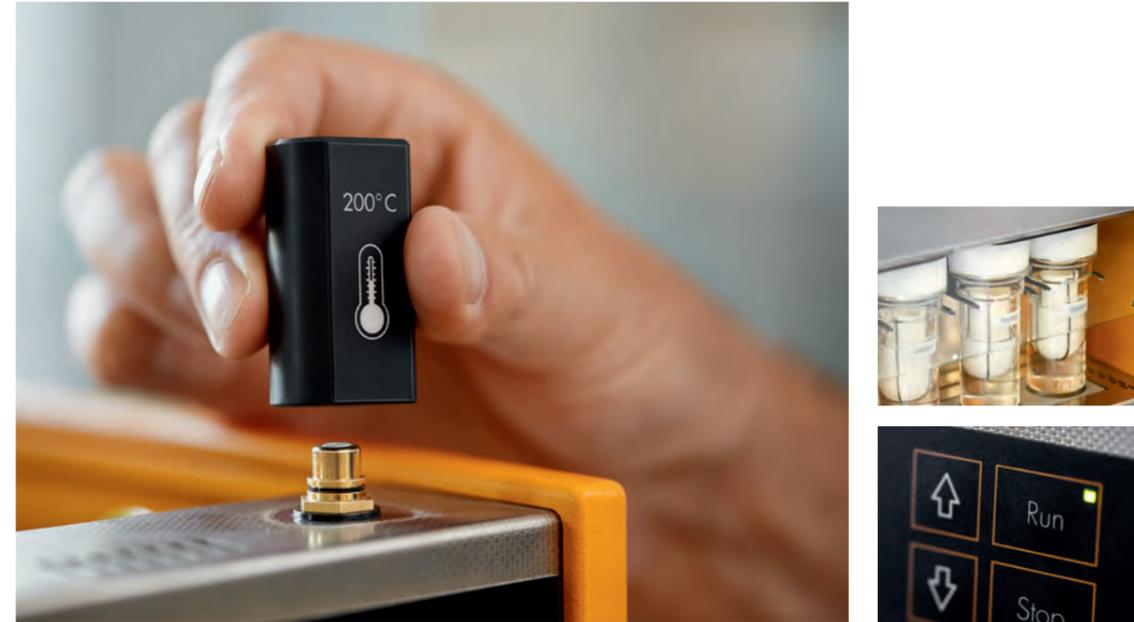
+ La **clavija de temperatura límite** enchufable por separado para 135°C, 200°C y 300°C, así como la **temperatura máxima programable** garantizan una doble seguridad. Si se supera la temperatura límite, la extracción se interrumpe automáticamente.
