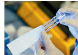
En el proceso FibreBag, digestión y filtración se llevan a cabo dentro de una bolsa filtrante de amplias dimensiones formada por un tejido especial de alta precisión, lo que permite normalizar las condiciones de filtración y su repetibilidad. Las bolsas FibreBag se incineran con los restos de la muestra después de cada proceso de digestión. Al usarse una sola vez, cada análisis tiene lugar en las mismas condiciones normalizadas de filtración, generándose resultados reproducibles con exactitud.
