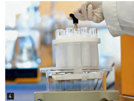
El tirador desmontable facilita el uso y la extracción del carrusel de muestras.
