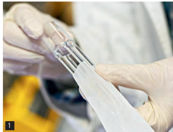
Fácil manipulación: insertar el separador de vidrio en la bolsa FibreBag, pesar la muestra y, listo. No es necesario cerrar la bolsa filtrante.
