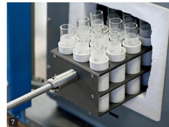
Con su larga empuñadura, el módulo de incineración facilita la manipulación de las muestras.
